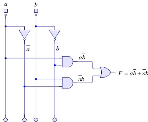
Para resolver un ejercicio de ANÁLISIS, iremos colocando a la salida de las diferentes puertas, el resultado de “la operación” (cómo se ha indicado en el circuito anterior). A la salida de la última puerta el resultado es el de la función que está implementada en el circuito.
